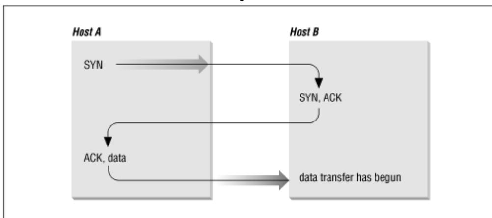
Dopo questo scambio, l'host A possiede una prova evidente che l'host B è pronto per ricevere i dati. Non appena la connessione è stata stabilita, i dati possono essere trasmessi. Quando i moduli cooperanti hanno concluso il trasferimento dei dati, scambieranno un three-way handshake con segmenti contenenti il "No more data from sender" (fine della trasmissione di dati, FIN bit) per chiudere la connessione.
