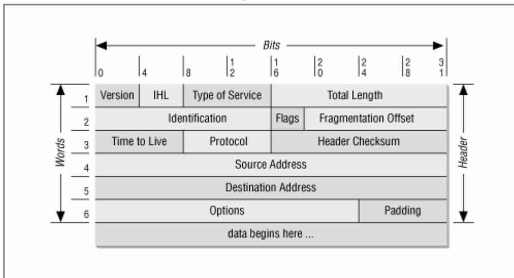
L'IP trasmette il datagramma cercando l'indirizzo di destinazione nella word 5 dell'intestazione. L'indirizzo di destinazione è un indirizzo standard a 32-bit (IP address) che identifica la rete di destinazione e l'host specifico della rete. Se la destinazione è l'indirizzo di un host che si trova nella rete locale, il pacchetto è consegnato direttamente a destinazione. Se l'indirizzo di destinazione si
