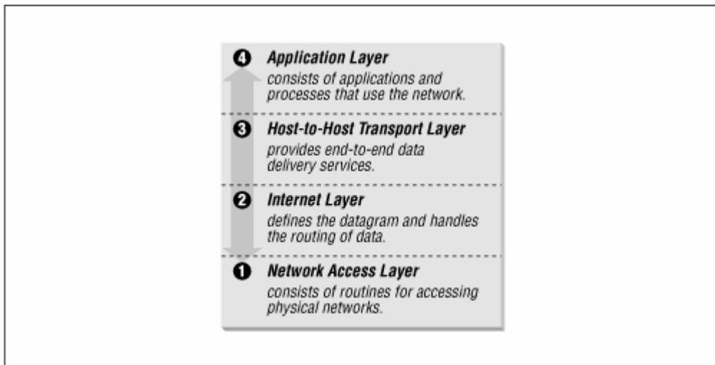
Come nel modello OSI, in fase di invio, i dati percorrono dall'alto verso il basso la pila (stack), mentre in fase di ricezione nel senso contrario.
