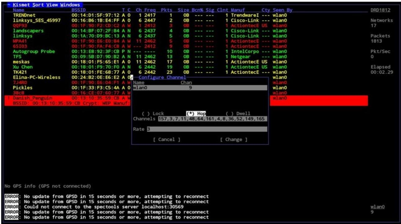
Data la versatilità di Kismet è possibile come è stato fatto notare prima in fase di configurazione di aggiungere un'altra interfaccia di rete in modo dinamico: *Kismet* > *Add Source* > *intf* = nome *interfaccia* (es *wlan1*), di default vengono caricate le impostazioni *IEEE80211b*, ma se specificato diversamente in *Opts* si possono caricare profili specifici.
